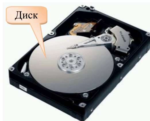
Рисунок 2.15. Винчестер SATA – 1000 GB Samsung HD103UJ, 32MB кэш, 7200 об/мин (со снятой верхней крышкой)
