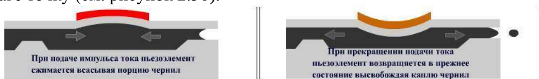
Рисунок 2.36. Принцип пьезоэлектрической технологии фирмы Epson
