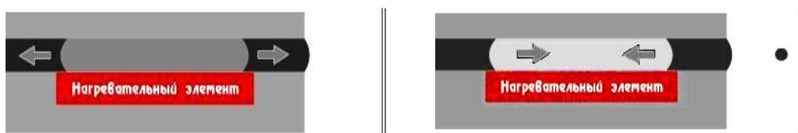
Рисунок 2.35. Принцип пузырьковой технологии ( bubble-jet ) фирмы Canon
