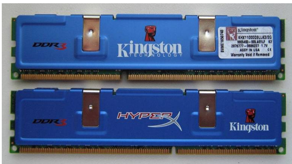
Рисунок 2.14. Модули памяти DDR3
