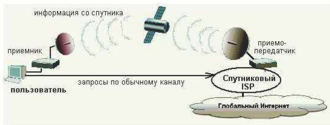
Рисунок 4.7. Схема асимметричного спутникового доступа в Интернет
