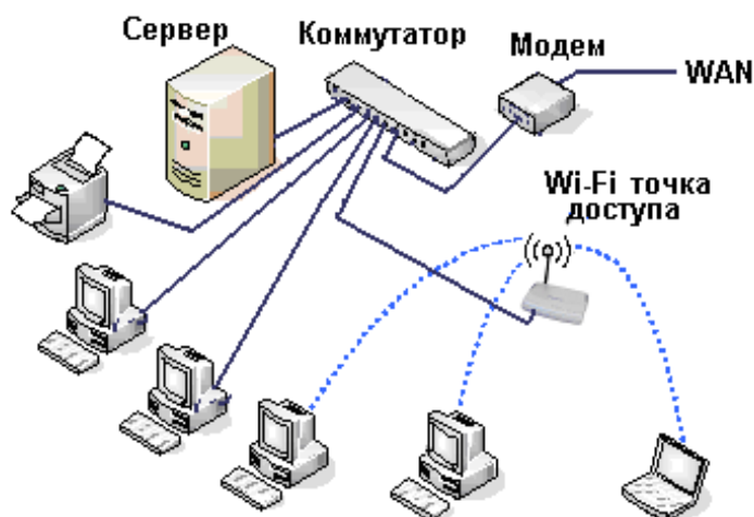
Рисунок 2.46. Локальная сеть с использованием Wi-Fi
