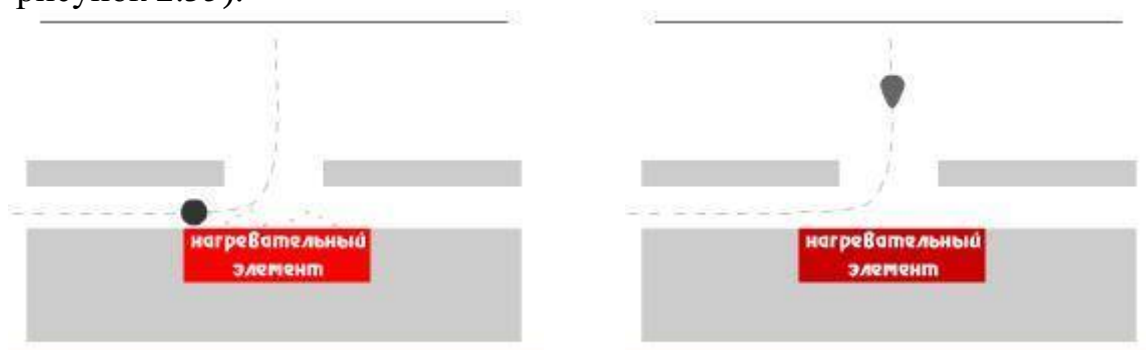
Рисунок 2.34. Принцип технологии drop-on-demand фирмы Hewlett-Packard
